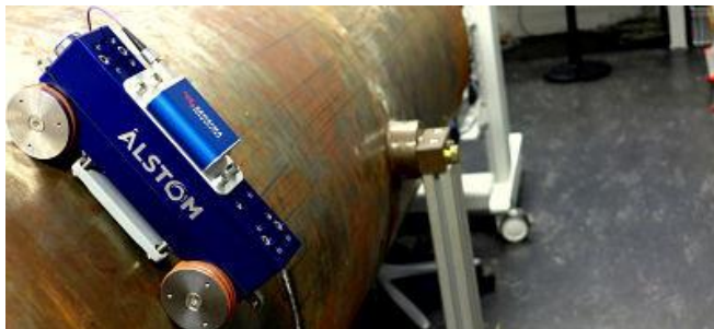
Der von der ETH Zürich entwickelte «AirGapCrawler» inspiziert die Kupferbahnen eines Generators und überprüft die Isolation. (Bild: ETH Zürich).
