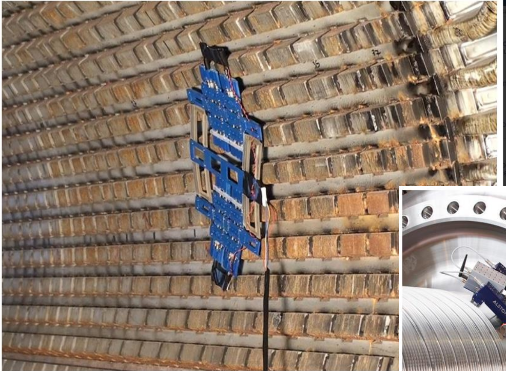
Der von der ETH Zürich entwickelte «AirGapCrawler» inspiziert die Kupferbahnen eines Generators und überprüft die Isolation. (Bild: ETH Zürich).
