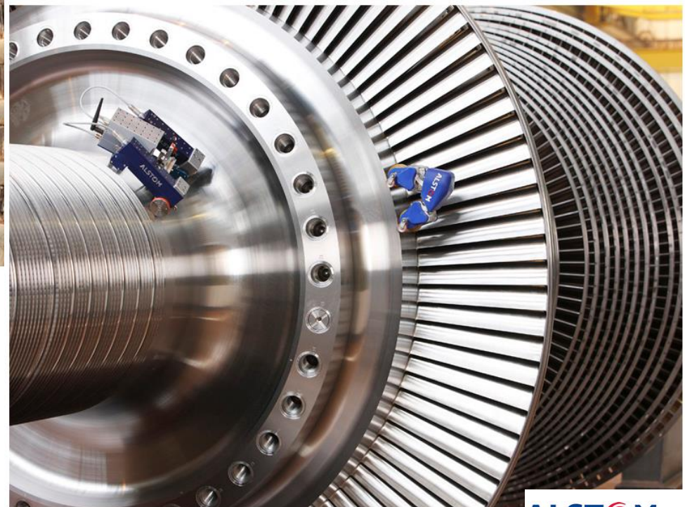
Die Inspektionsroboter arbeiten bedeutend schneller als ihre menschlichen Vorbilder. Hier eine Testfahrt auf einer Dampfturbine. (Bild: Alstom Inspection Robotics)
